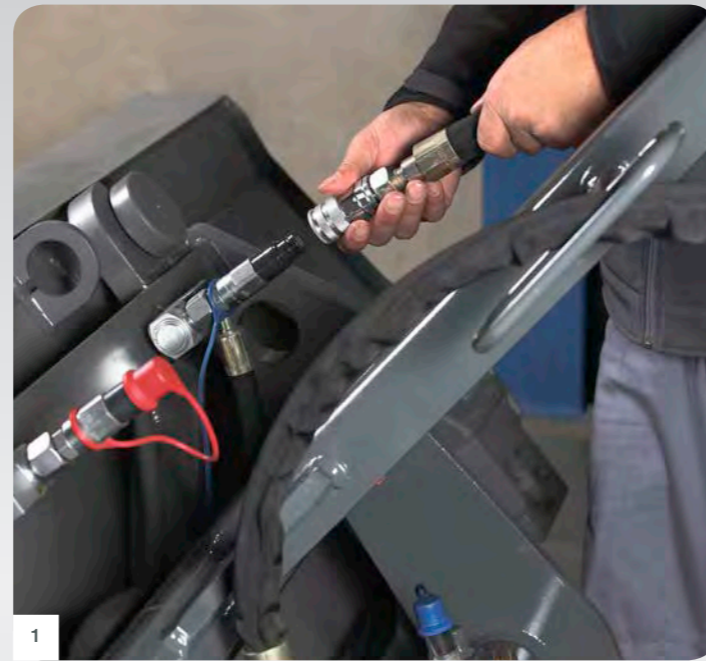
1 Einfache und sichere Anbindung des Anbaugerätes
