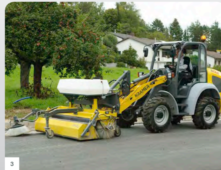
2 Mulcheinsatz mit powerflow Leistungshydraulik 3 Kehmaschineneneinsatz mit effizientem 3. Steuerkreis (serienmäßig)
