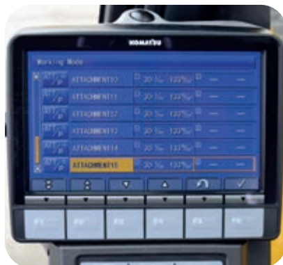
Komatsu Integrated Attachment Control (KIAC) mit bis zu 15 Voreinstellungsmöglichkeiten für Ölstrom und -druck (optional)
